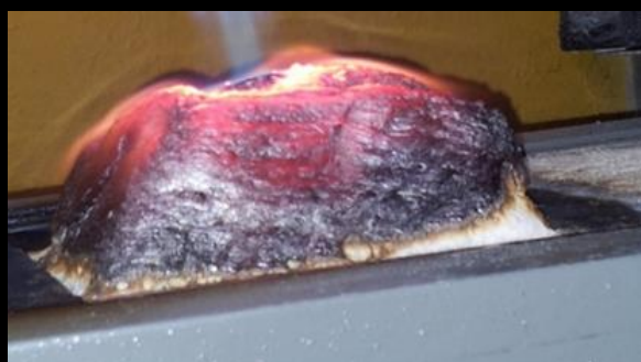
Zdj. 2. Spęczniała warstwa lakieru powstała pod wpływem ognia.
