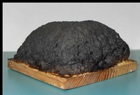
Zdj. 2. Spęczniała warstwa lakieru powstała pod wpływem ognia.
